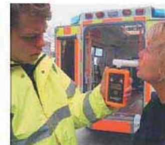
Stecken Sie das Mundstück auf den T-Adapter und anschließend das T-Stück in das Gerät ein. Vergewissern Sie sich über die richtige und "Gasdichte" Verbindung aller Teile.
